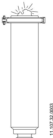
При монтаже фильтра следует избегать слишком сильного напряжения и обращать внимание на:
